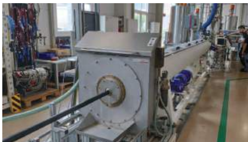
Im Forschungsprojekt „EWS.MWCNT“ werden PE-CNT-Rohre mit verbesserter Wärmeleitfähigkeit entwickelt (Foto: SKZ)
