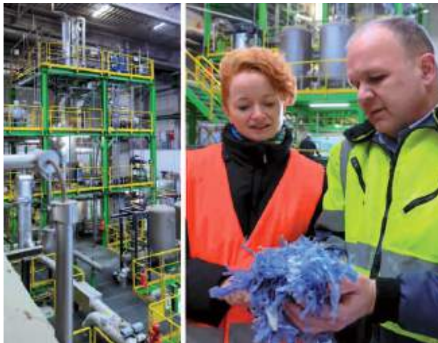
Chemische Recyclinganlage in Ennigerloh, Nordrhein-Westfalen: In dieser Anlage werden komplexe Kunststoffabfälle in ihre chemischen Grundstoffe zerlegt. Beim chemischen Recycling entstehen Öle, Gase und Feststoffe, die wieder für die Herstellung neuer Kunststoffe genutzt werden können und fossile Rohstoffe im Produktionsprozess teilweise ersetzen (Foto: © Plastics Europe Deutschland)
