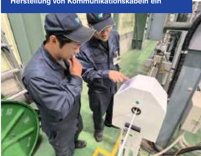
Kansai Tsushin Densen setzt SIKORAs CENTERVIEW 8000 zur Qualitätskontrolle bei der Herstellung von Kommunikationskabeln ein
