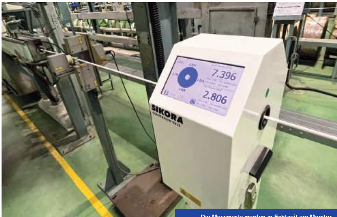
Die Messwerte werden in Echtzeit am Monitor des CENTERVIEW 8000 angezeigt
