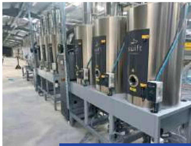
swift Trocknungstrichter mit großen Reinigungstüren (Foto: Tepro)
