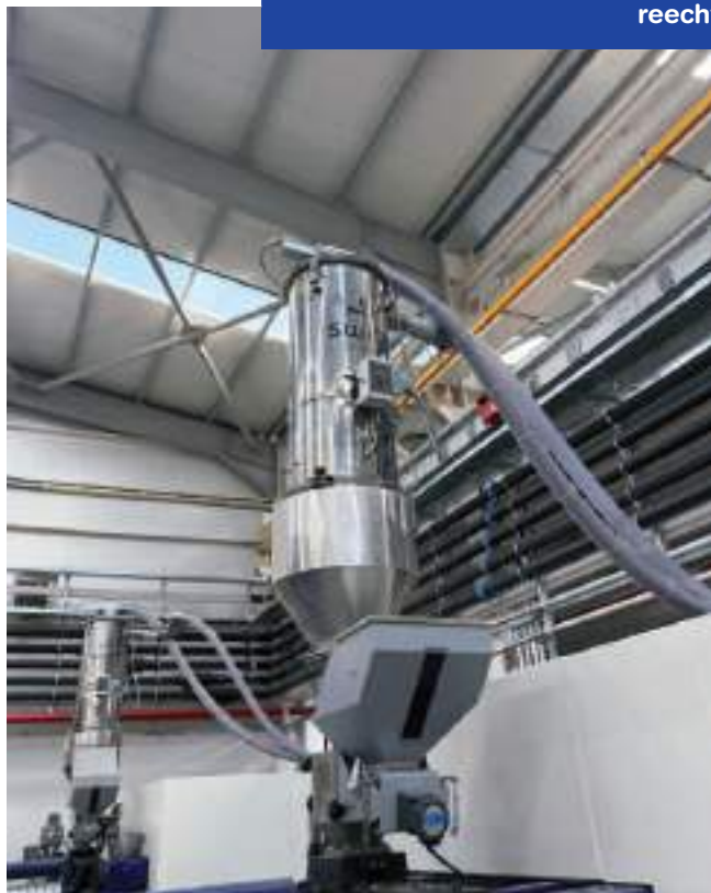
links: Volumetrische Dosiergeräte sCOLOR V, montiert auf Spritzgießmaschinen, rechts: motan Kupplungsstation mit Verrohrung (Fotos: Tepro)
