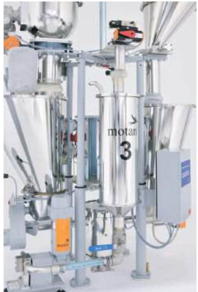
Gravimetrische Synchrondosier- und Maschstation Graviplus mit Flüssigdosiereinheit (unten links) (Alle Bilder: motan)
