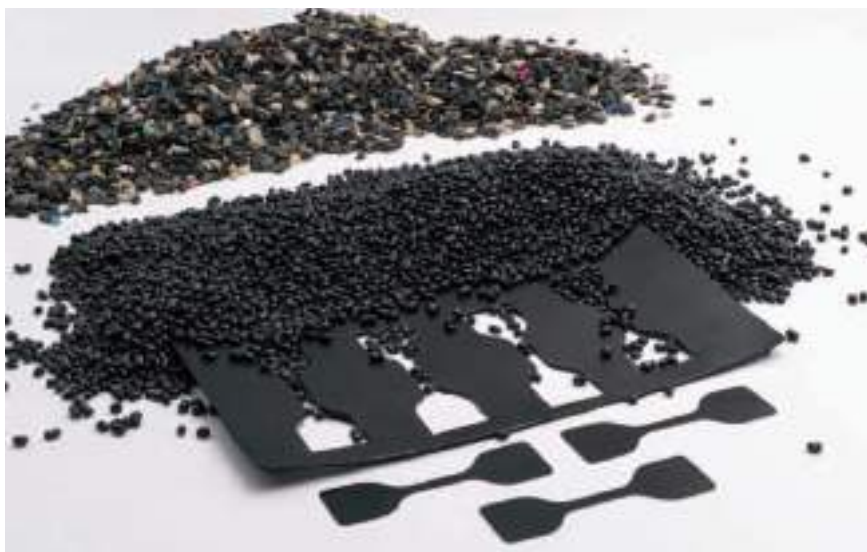
Mahlgut, Rezyklatcompound, Folie und Probekörper für den Strain Hardening Test (Foto: Luca Hoffmannbeck, SKZ)
