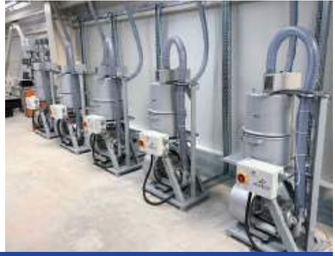
Links: swift Trockner Typ sDRY 250 mit integrierter Taupunktregelung, rechts: Gebläsestationen und Filter (Fotos: Tepro)
