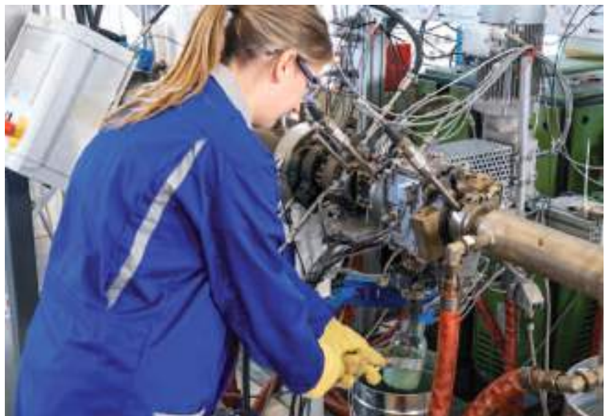
Probenentnahmen von Reaktionsprodukten aus dem kontinuierlichen chemischen Recyclingprozess (Foto: Luca Hoffmannbeck, SKZ)
