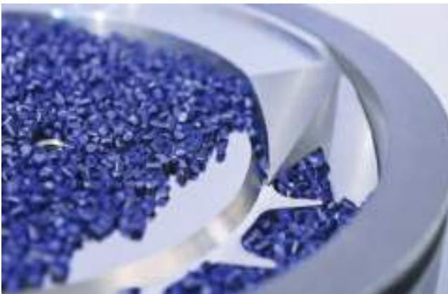
Scheibendosierorgan mit integriertem Messer als Abstreifer
